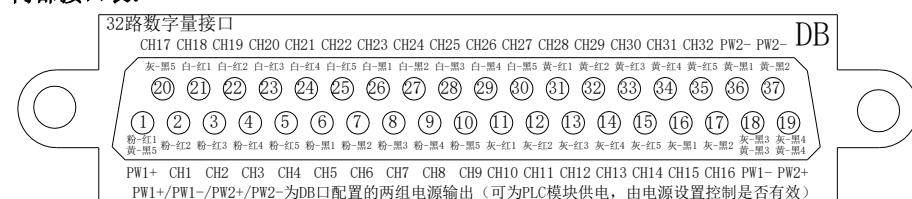
注：使用 MTL4517/4617 时，只安装 15 块隔离栅，第 32 路为 LFD 输出。
